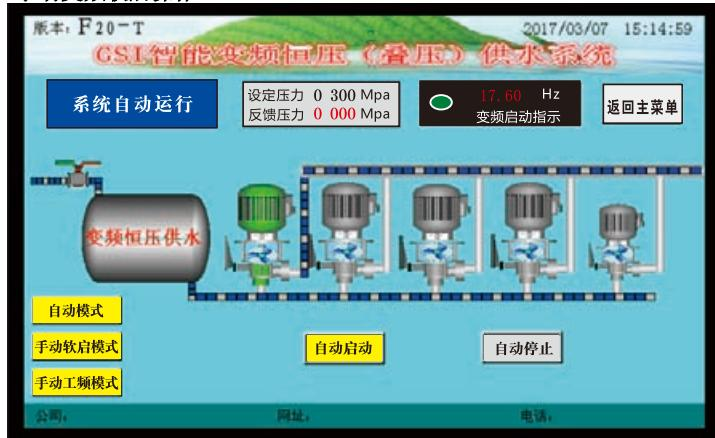
触控左下角的手动软启模式按钮，此按钮将变成黄底色。此时系统转成手动软启模式。每台水泵下面都有启动按钮及停止按钮。触控启动按钮相应水泵启动、触控停止按钮相应的水泵停止。（软启模式说明：水泵电机手动启动时先按用变频器按设定好的加减速时间启动水泵，等水泵变频运行到 50HZ 延时 2 秒切至工频回路工作。因为系统只有一台变频器，不能同时启动多台水泵，只有上一台启动完成并转至工频运行后才能启动下一台水。）
