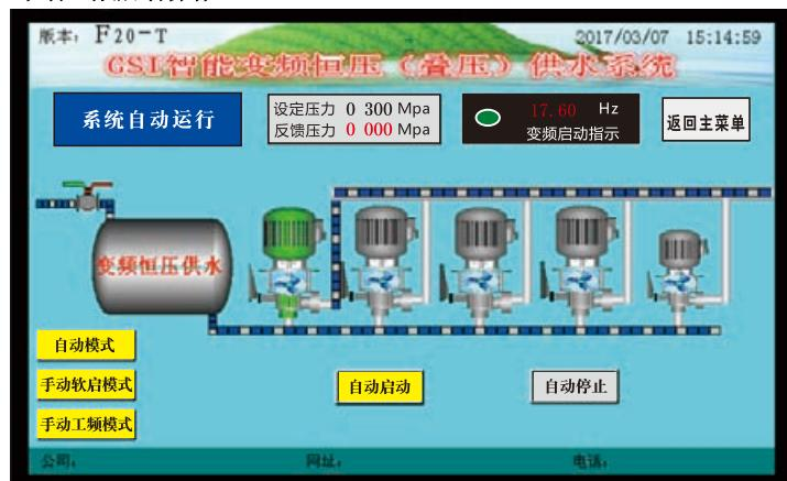
触控左下角的手动工频模式按钮，此按钮将变成黄底色，此时系统转成手动软启模式。每台水泵下面都有启动按钮及停止按钮。触控启动按钮相应水泵启动、触控停止按钮相应的水泵停止。(手工工频模式说明：当按启动按钮时水泵以工频直接启动、按停止按钮时水泵停止)。
