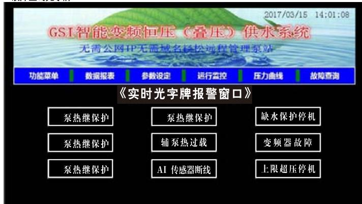
当有故障时对应的光字牌变成红色。有此故障消失后会自动启动系统以保证供水实时性，但有些故障是设备自身硬件故障需维修后按复位键复位。
