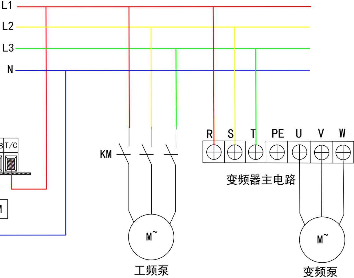
温馨提示：一变一工是指变频器为主，工频为辅。当变频器运行到50Hz且反馈压力低于设定压力时，经延时E0.35后，TB/TC导通，直接启动工频水泵补压。
